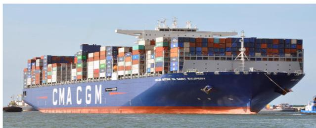
Il s'agit du « **CMA CGM Antoine de Saint-Exupéry** ». Construit aux Philippines, ce navire d'exception mesure 400 mètres de long pour 59 de large. Avec un tirant d'eau de 16 mètres et un tonnage de 200 000 tonnes, il a un moteur de 100 000 CV qui peut le propulser à la vitesse de 22 nœuds (41 km/h). Doté d'une capacité de 20 600 conteneurs standards, il était, en 2018, le 7ème plus grand porte-conteneurs du monde !
